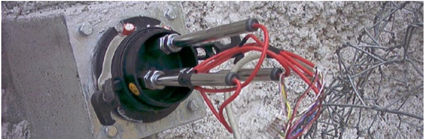
MPBX-Kopf mit Wegaufnehmern, installiert an einer Stützmauer
